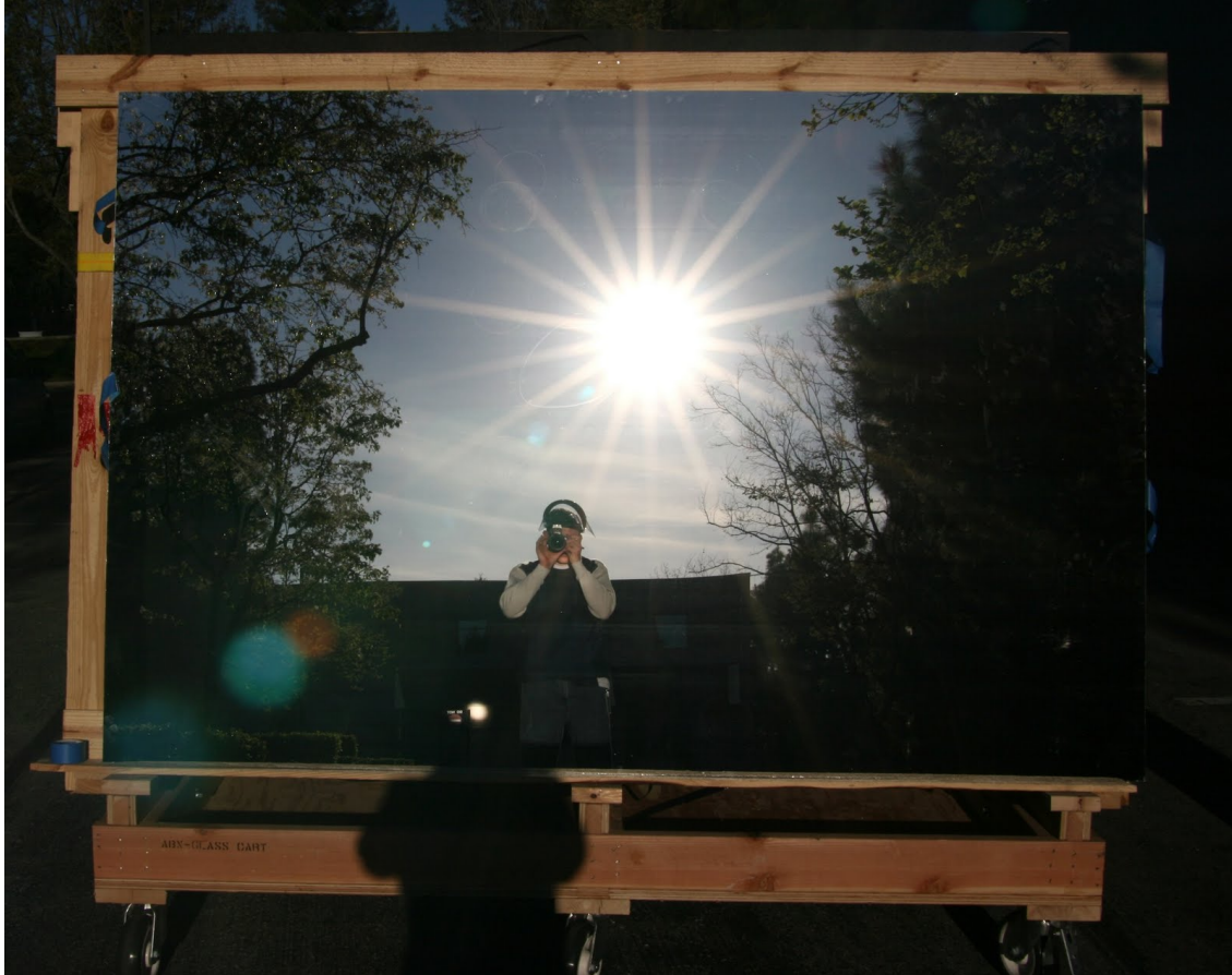
A 2m x 3m heliostat mirror
